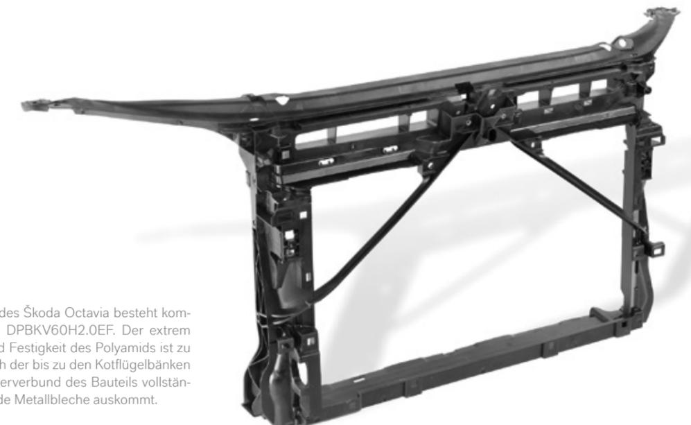
Der Frontendträger des Škoda Octavia besteht komplett aus Durethan® DPBKV60H2.0EF. Der extrem hohen Steifigkeit und Festigkeit des Polyamids ist zu verdanken, dass auch der bis zu den Kotflügelbänken reichende obere Querverbund des Bauteils vollständig ohne verstärkende Metallbleche auskommt.
