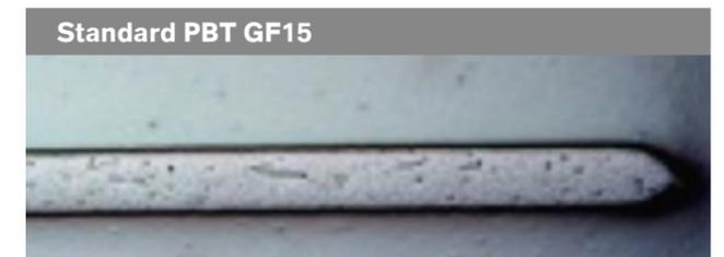
■ Steckerleisten lassen sich mit Pocan® B3217XF filigran konstruieren, weil auch sehr dünnwandige Bauteilbereiche dank der gleichmäßig orientierten Glasfasern ausreichend mechanisch stabil sind.
