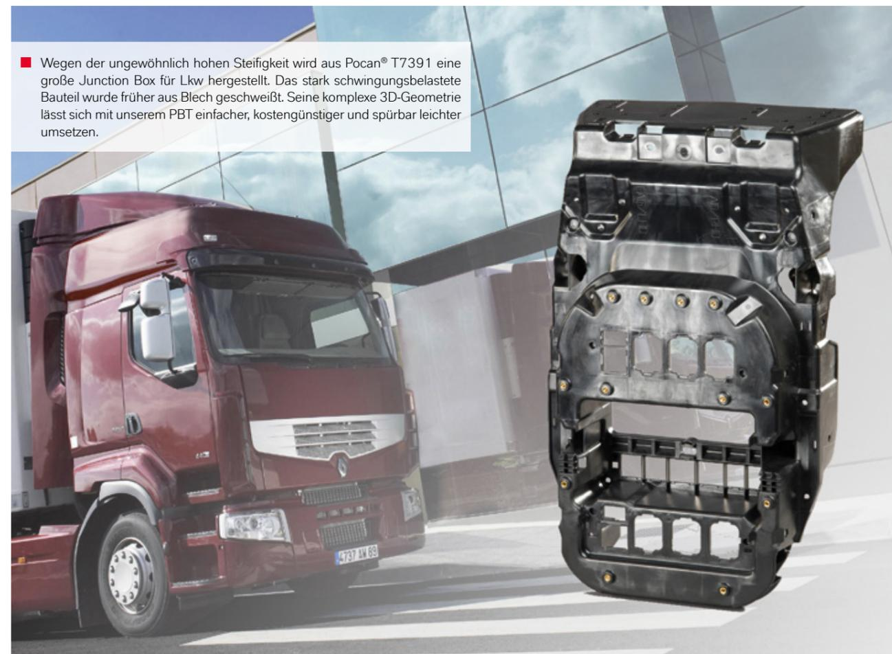
■ Wegen der ungewöhnlich hohen Steifigkeit wird aus Pocan® T7391 eine große Junction Box für Lkw hergestellt. Das stark schwingungsbelastete Bauteil wurde früher aus Blech geschweißt. Seine komplexe 3D-Geometrie lässt sich mit unserem PBT einfacher, kostengünstiger und spürbar leichter umsetzen.
