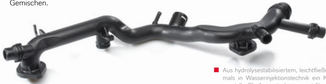
■ Aus hydrolysestabilisiertem, leichtfließendem Durethan® wurde erstmals in Wasserinjektionstechnik ein Kühlwasserrohr gefertigt. Eine spezielle Glasfasermischung sorgt für sehr glatte Außen- und Innenoberflächen des Rohres.
