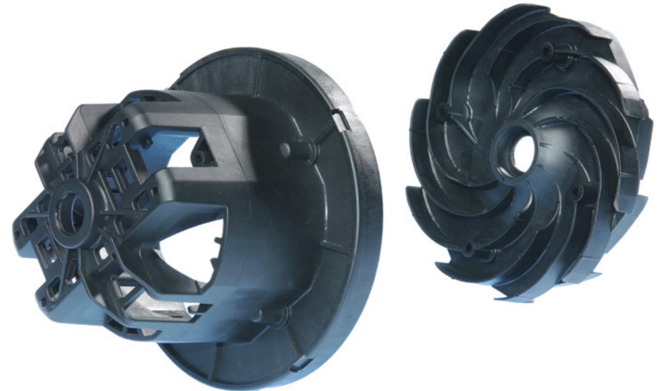
■ Stator und Rotor für ein Elektro-Gebläsemotor aus dem dynamisch hoch belastbaren Pocan® T7391. Die Fertigung beider Komponenten im Metall-Druckgussverfahren hätte wegen ihrer komplexen Geometrie viel Nacharbeit bedeutet. Das PBT ermöglicht zudem eine beträchtliche Gewichtsersparnis.
