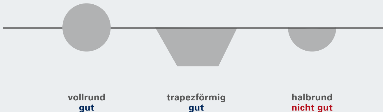
Bild 6: Geeignete und ungeeignete Angusskanalquerschnitte für ALFATER XL ®.
