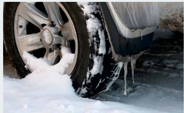
Bild 1: Spritz- und Schmutzschutz hergestellt im Spritzgussverfahren.
